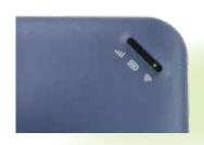
**4.** LEDがしばらく点滅 (1分) し、 左図のように LED が点灯すれば 使用できます
